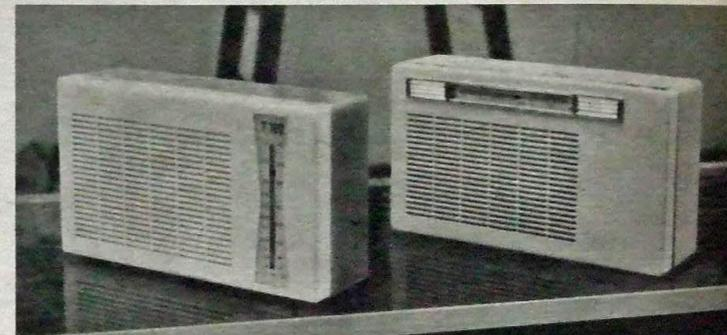
Die beiden Taschenempfänger „T 100“ und „T 101“ kommen aus Berlin. Technisch sind sie gleich aufgebaut, unterschiedlich ist nur die Anordnung der Skalen. Empfangen kann man damit im Kurz-, Mittel- und Langwellenbereich. Ihre Gehäuse sind aus pastellfarbenem Polystyrol. Die Abmessungen: 135 x 92 x 46 mm. Eine gute Leistung!
