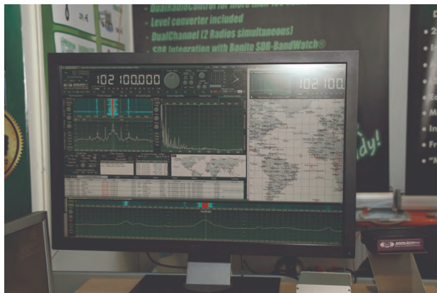
Bild 6: SDR am Stand von Bonito: Diese Neuentwicklung nutzt den Realtek-Stick für die Signalaufbereitung. Hier: Empfang von FM4 auf 102,10 MHz.
