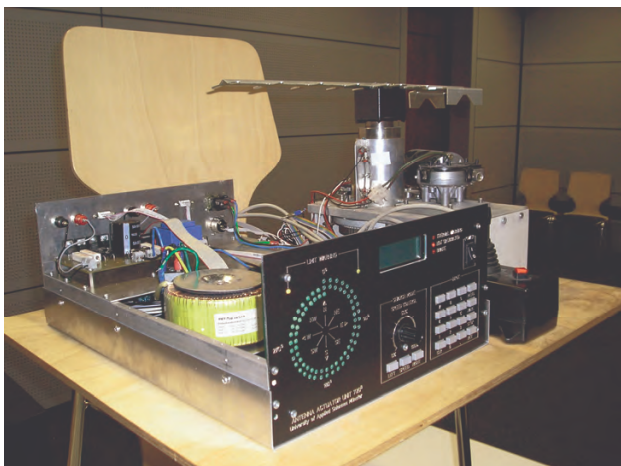
Bild 2: Ein mikroprozessorgesteuerter Antennenrotor, entwickelt an der FH Münster und der Leitung von Dr.-Ing. Dirk Fischer, DK2FD.
